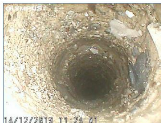
Immagine a 130 cm dalla fine del foro. Conglomerato a base di sabbia.
